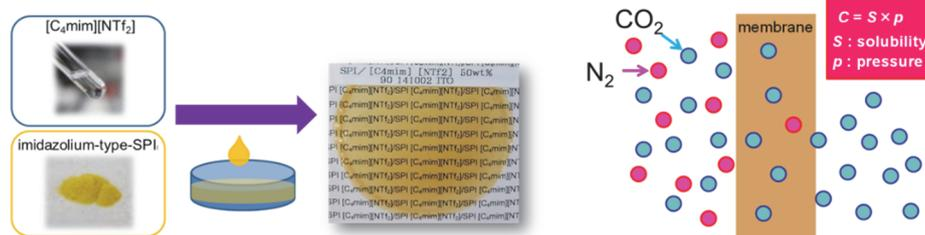
図10 ポリイミドを用いたイオンゲルの作製 (左) と CO<sub>2</sub> 分離の概念図 (右)。
