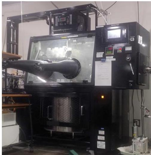
図1 電気炉付きグローブボックス
